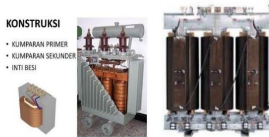
Gambar 2. 3 Kumparan transformator Sumber : slideplayer.info
