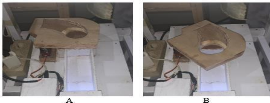
Gambar 10. A. Sudut Servo 2 ke 40°, B. Sudut Servo 2 ke 90°
