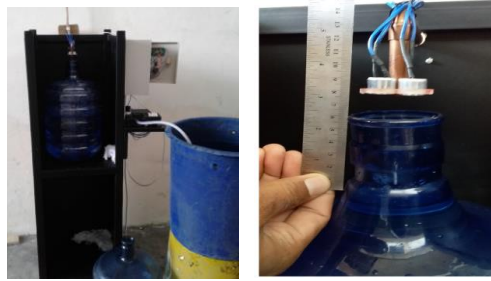
Gambar 9. Proses Pengisian dan Pengukuran Level Air Dengan Sensor
